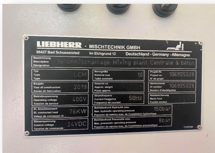
Slika 3.1: Oznaka sa karakteristikama planiranog postrojenja za miješanje betona marke LIEBHERR 1.0 LCM
