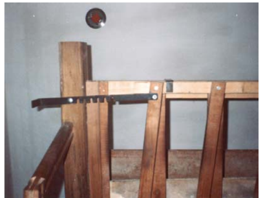
Slika 13. Primjer poluge - zatvarača na izmuzištu
