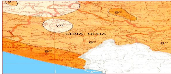
Privremena seizmološka karta teritorije SFRJ (dio za Crnu Goru) sa elementima očekivanog maksimalnog intenziteta zemljotresa, za povratni period od 500 godina (1987. godina).
