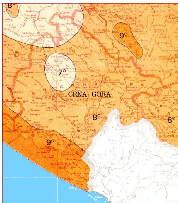
Privremena seizmološka karta teritorije SFRJ (dio za Crnu Goru) sa elementima očekivanog maksimalnog intenziteta zemljotresa, za povratni period od 500 godina (1987. godina).
