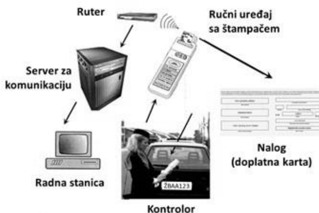
Slika P3.3: Skica rada sistema kontrole i sankcionisanja parkiranja
